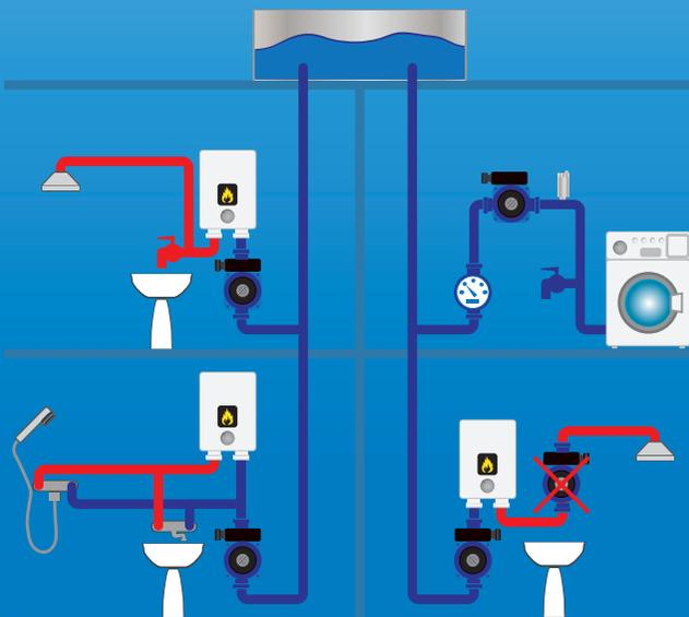
Внимание: Не устанавливать насос в систему горячего водоснабжения
